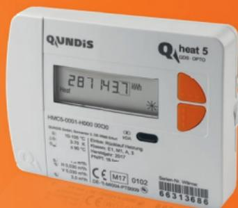
\* Durch das kurze Drücken einer der beiden Gerätetasten wird die schnelle Anzeigenschleife aktiviert. Nach 10 Wiederholungen wechselt das Display automatisch wieder in den sogenannten Schlafmodus. Bei kombiniertem Wärme-/Kältezähler sind zusätzliche Anzeigeschritte möglich.
